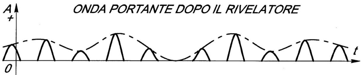
Le cuffie erano elettromeccaniche fatte in modo da far vibrare dei dischi in ferro piatto, a guisa di timpano, che producevano il suono di bassa frequenza, come indicato dalla linea mista, e riproducevano ottimamente la trasmissione (il "timpano" metallico non era in grado di vibrare a frequenze radio). Se l'antenna riusciva ad assorbire molta potenza (parliamo comunque di frazioni di watt) la trasmissione era udibile anche ad una certa distanza dalla cuffia!
